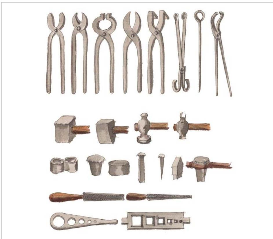
Ferramentas dos ferreiros: 1, 2, 3, tenaces, 4, tenaces de corte, 5, tenaces de volta, 6, tenaces de lume, 7, atizador, 8, tenaces curvas, 9, esteixador, 10, 11, 12, martelos, 13, sufrideira, 14,15, tufos, 16, tronzafrío, 17, punzón, 18,19, talleiras, 20,21, limas, 22,23, talleiras.
